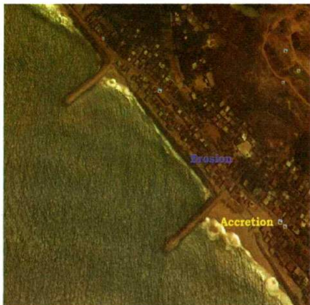
ग्रोइन समुद्र या नदी के किनारे लंबवत निर्मित एक कठोर हाइड्रोलिक संरचना
